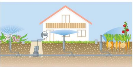
Jede Pipelife Bewässerungsanlage ist ein professionelles System mit Steuereinheit, Regenmessgerät, Verbindungsrohren, Versenkregnern und Versenkdüsen.
